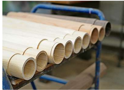
Dass das Instrument aus jeweils zwei ausgefrästen, zusammengeklebten Hälften besteht, ist kaum sichtbar.
